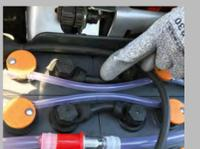
**Contrôle du niveau d'électrolyte**
